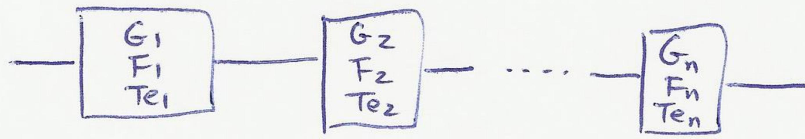
$$T_{\text{Cas}} = T_{e1} + \frac{T_{e2}}{G_1} + \frac{T_{e3}}{G_1 G_2} + \dots + \frac{T_{en}}{G_1 G_2 \dots G_{n-1}}$$
